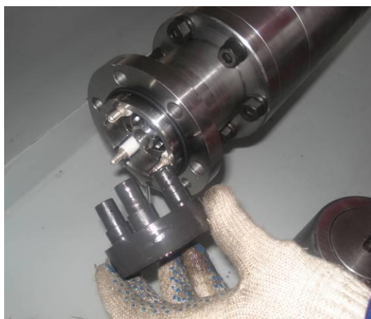
Фото 5: Демонтаж разъема «Звезда»
