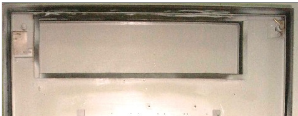
Рисунок 2.12 – Пластины уплотнения на панели оператора
