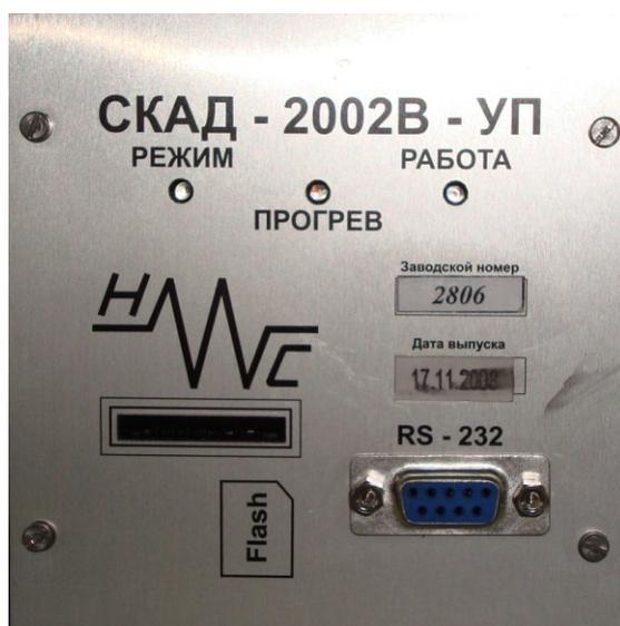
Фото 1. Расположение элементов индикации и управления на передней панели «СКАД-2002-УП»
