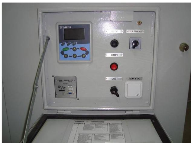
Фото 9. Внешний вид отсека оператора после установки блока управления
