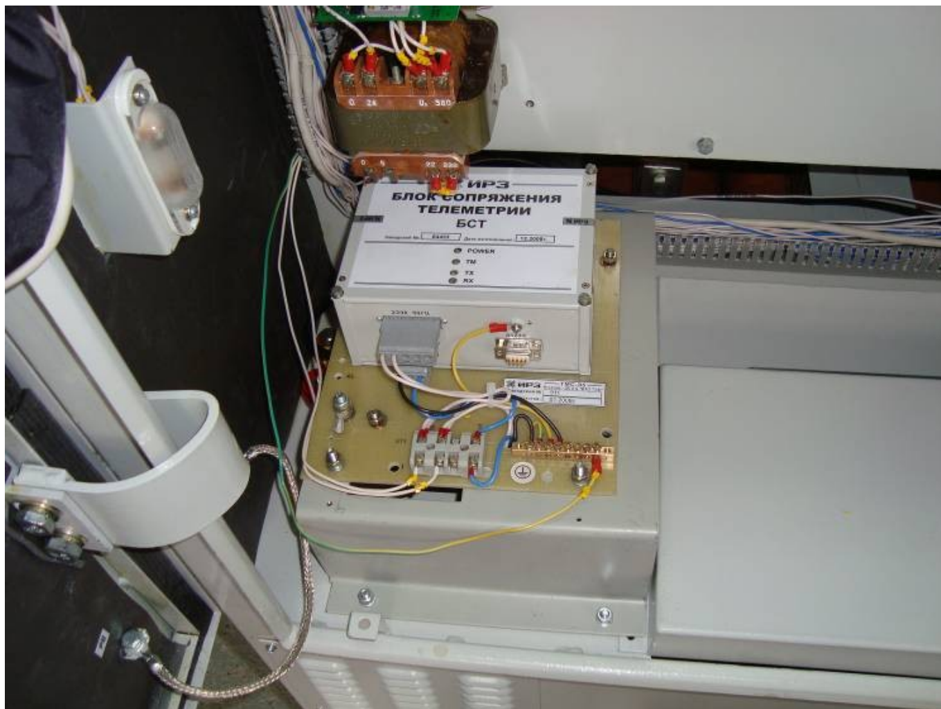
Рисунок 2.5.2 – Наземный блок ТМС-Э5, установленный на дне СУ ИРЗ-500.
