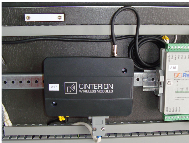
Рисунок 2.2 – Модем с установленной антенной
