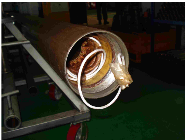
Фото 7: Основание ПЭД с выведенным «0» проводом
